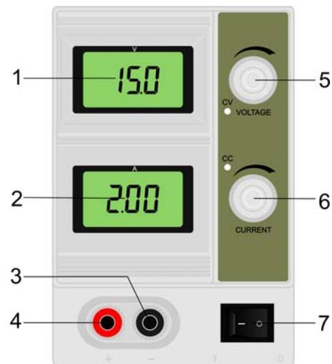
Устройство имеет дисплей выхода. Дисплей имеет 2 показания: тока и напряжения. На выходе 0-15 Вольтов с 0-2 Амперами. Стандартное напряжение на входе только 220В АС и защита с помощью предохранителя.
